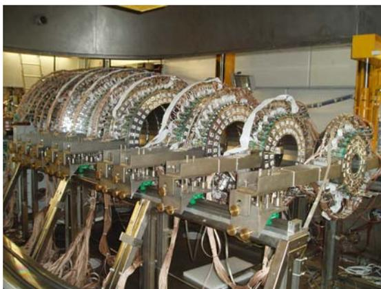
Fig. 1 The CHIMERA multi-detector at the Laboratori Nazionali del Sud (LNS)
